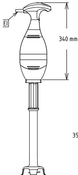
EI = Conexión eléctrica (energía)
